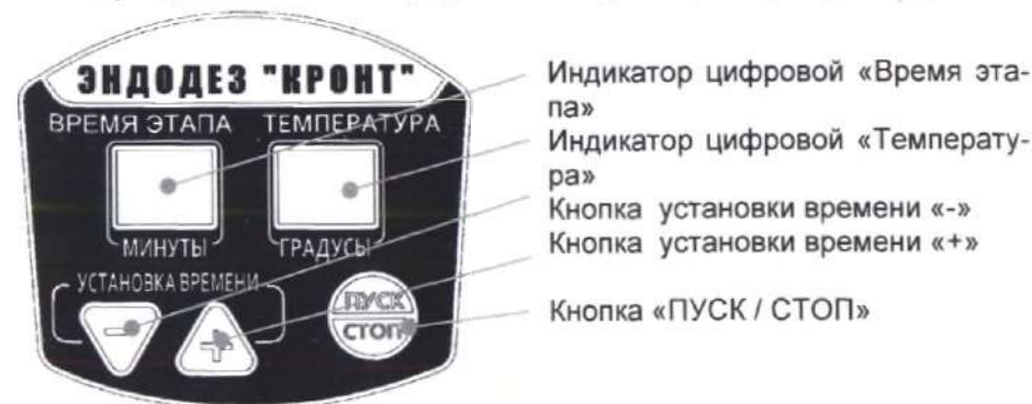
Рис.14 Панель управления блока питания и управления
